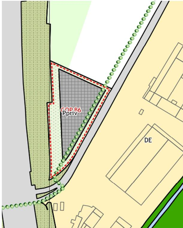
Nello schema precedente è stata verificata una soluzione per la messa in sicurezza degli interventi in cui è previsto il rialzamento delle quote attuali per le aree a parcheggio e la mitigazione degli effetti connessi a tali modifiche dell'assetto del territorio mediante compensazione dei volumi di acqua spostati dall'intervento. In fase di progettazione attuativa o esecutiva degli interventi edilizi potranno essere sviluppate soluzioni alternative in osservanza dei contenuti della LR 41/2018.
